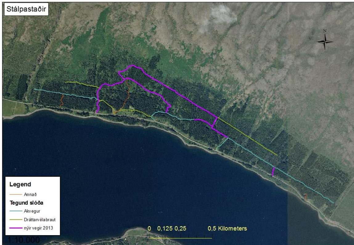
Mynd 4 sýnir vinnuvegi á Stálpastöðum í Skorradal. Blár sýnir vegi sem búið var að laga fyrir 2013, fjólublár sýnir vegi sem gerðir voru árið 2013 og grænleitu vegirnir eru þeir vegir sem eftir er að laga. Mynd VR
