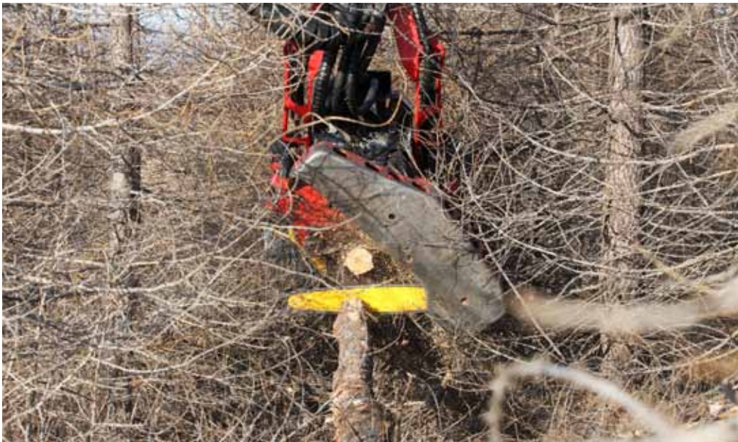
Keðjusagarblað á fellihausnum sker bolina í fyrir fram ákveðnar lengdir. Tekið í Mjóanesi á Fljótsdalshéraði. Ljós. Pétur Halldórsson
