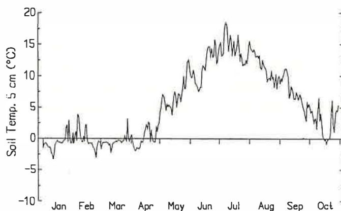
Mynd 3.8. Meðaljarðvegshiti sólarhringsins á 5 cm dýpi 1. janúar til 31. október, 1991. Daily mean soil temperature at 5 cm depth January 1 - October 31, 1991.
